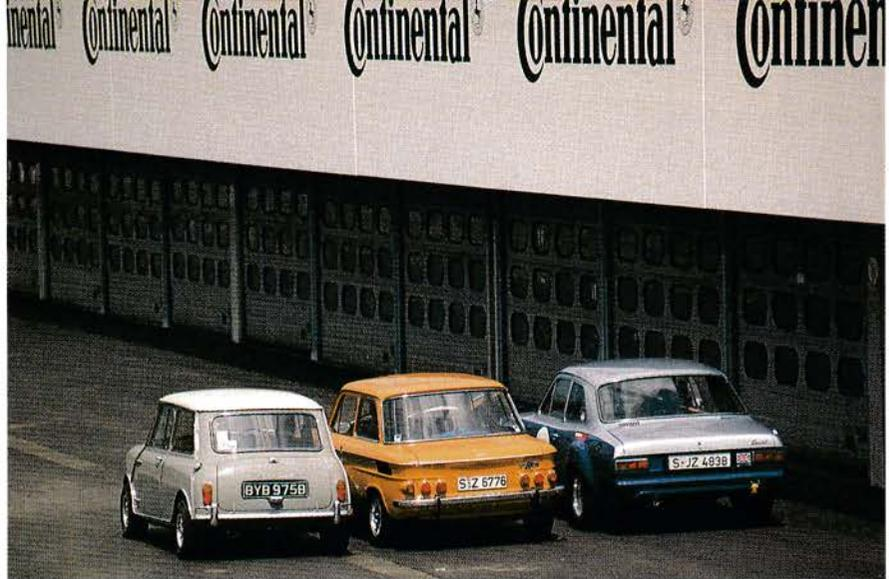
*Drei Renner, drei Konzepte: Im Ford Escort TC treibt ein vorn eingebauter Lotus-Motor die Hinterräder an, im NSU TTS sorgt ein quer eingebauter und luftgekühlter Heckmotor an den Hinterrädern für Vortrieb, und im Mini läßt der ebenfalls quer eingebaute Frontmotor die Vorderräder drehen. Beim Einsatz auf der Rennstrecke sind sie sich ähnlich – alle drei sind schnell.*
