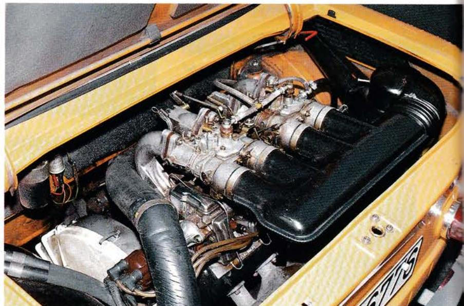
Der luftgekühlte Vierzylinder des NSU verschwindet fast gänzlich unter der dominanten Vergaser-Batterie, der Einliter-Motor entwickelt nervöse und laute 70 PS.
